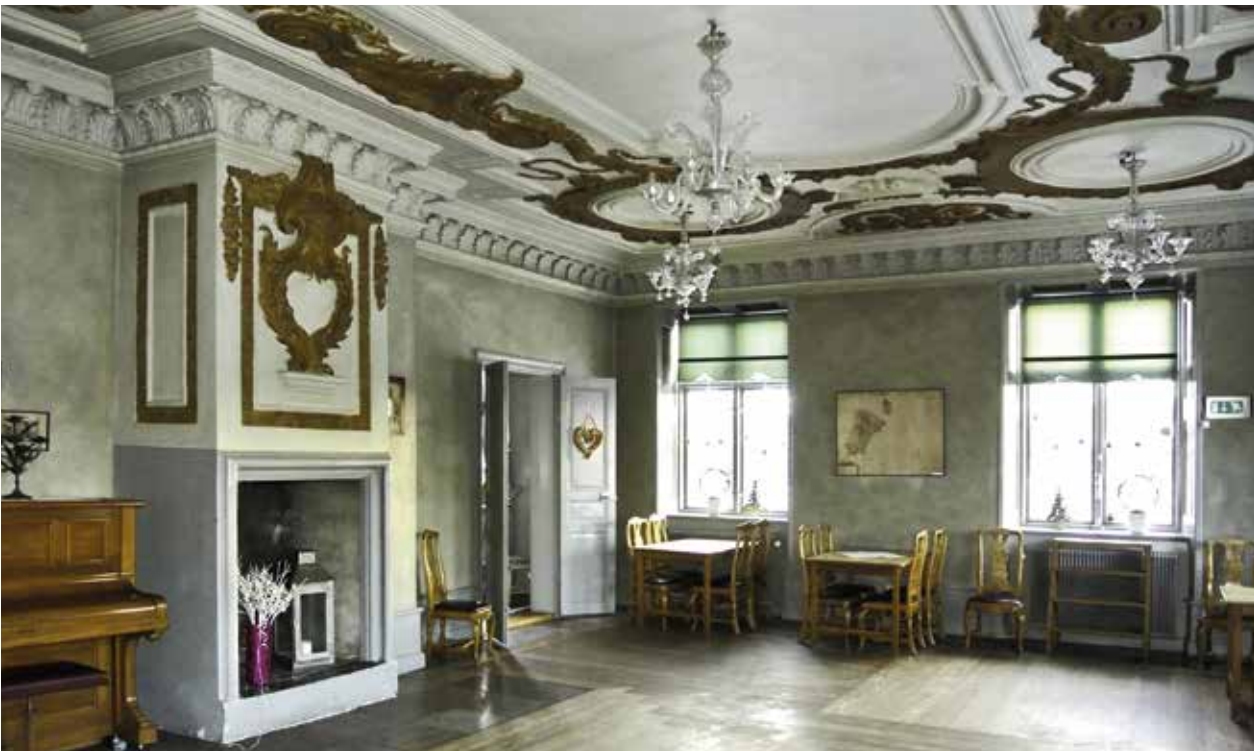
Interiör från Ängby gård, Norra Ängby. I den stora salen på det övre våningsplanet finns en bevarad påkostad inredning med stucktak och en dekorerad öppen spis från 1690-talet. Den låga fotpanelen nytillverkades på 1950-talet för att förstärka rummets barockkaraktär, pardörrarna är från 1700-talets senare hälft.
