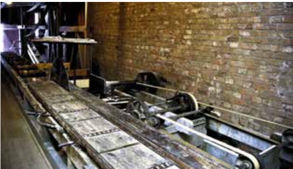
Sågen är från den ursprungliga anläggningen. Biprodukten, sågspånet, användes för eldning av den ångmaskin som ibland ersatte vattenturbinen för drift av kvarnstenarna.
