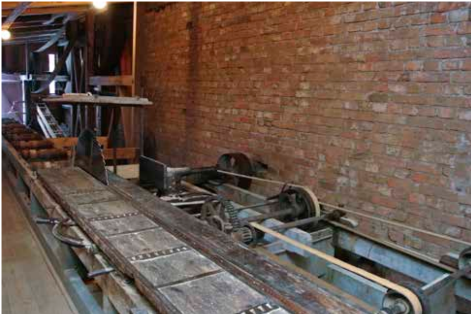
ÄVEN SÄGEN BEVARAS FRÅN DEN URSPRUNGLIGA ANLÄGGNINGEN. SÄGEN VAR TILL SKILLNAD FRÅN KVARNVERKSAMHETEN FRÄMST AVSEDD FÖR FASTIGHETSÄGARENS EGNA BEHOV. BIPRODUKTEN, SÄGSPÅNET, KUNDE DOCK ANVÄNDAS FÖR ELDNING AV DEN ÅNGMASKIN SOM IBLAND ERSATTE VATTENTURBINEN FÖR DRIFT AV KVARNSTENARNA. FOTO J. MALMBERG.
