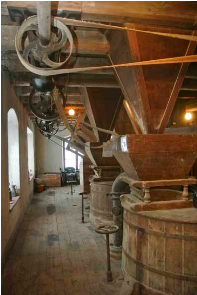
KVARNBYGGNADENS BOTTENPLAN INRYMMER SJÄLVA KVARNRUMMET MED KVARNSTENARNA. SÄDEN SLÄPPS NER TILL KVARNSTENARNA FRÅN VINDSPLET VIA STORA TRÄTRATTAR. FOTO J. MALMBERG.
